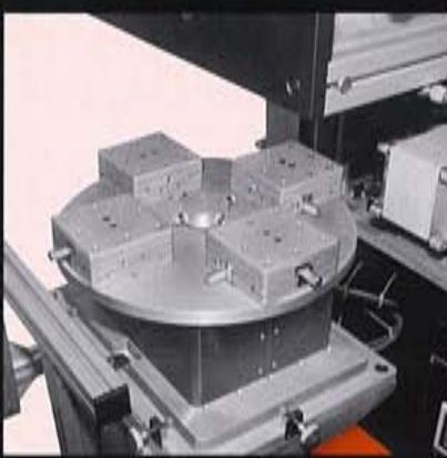
■「スペース パッド トランス 802 GT」は、2個の独立したパッドを直線アームにセットした、4分割ターンテーブル方式パッド印刷機です。
